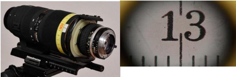
G) Zwei Objektiv, an den Frontlinsen mittels eines Adapters zusammengeschraubt, sind auch eine Möglichkeit, Kleines groß abzubilden. Aus dem Verhältnis der Brennweiten ergibt sich der Abbildungsmaßstab: ein 50-mm-Objektiv vor einem 200-mm-Objektiv ergibt z.B. vierfache Vergrößerung. Das vorgeschaltete Objektiv sollte einen größeren Frontlinsendurchmesser haben als hintere, um Vignettierung zu vermeiden.
